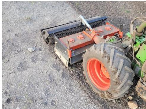
Abbildung 17 Links: Walze mit Einsaat-Vorrichtung; Rechts: Traktor mit Kreiselegge
