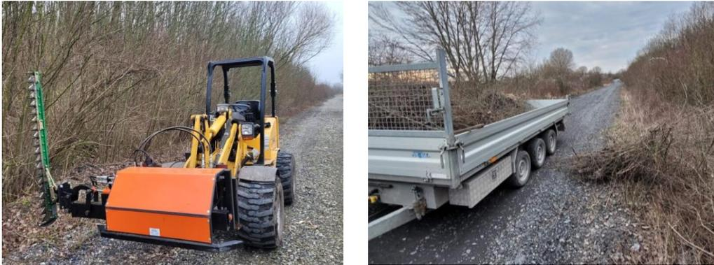
Abbildung 11 Links: Die an den Minibagger angebaute Heckenschere; Rechts: Das Schnittgut wurde gesammelt und in der Reisighecke verarbeitet.
